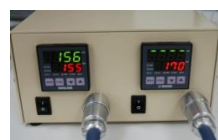
デジタル温度 コントロー
