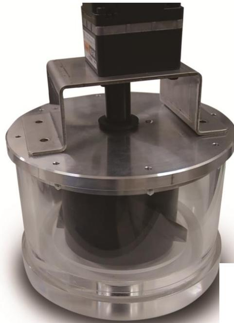
攪拌用フィン形状、回転数などの評価用にカスタムで製作対応した例です。
